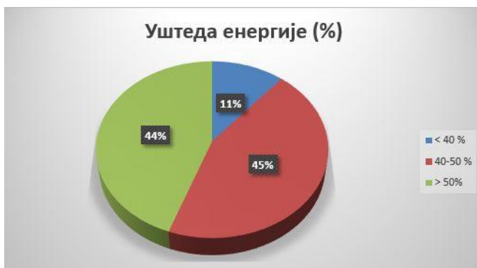
Слика 7. Уштеда енергије (%) у школама у Пернику након спроведеног система мера енергетске ефикасности
